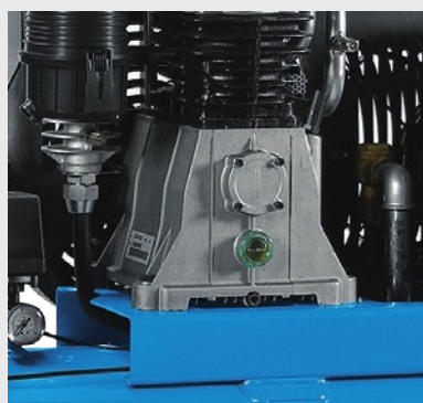
Olejoznak pro snadný odečet stavu oleje
