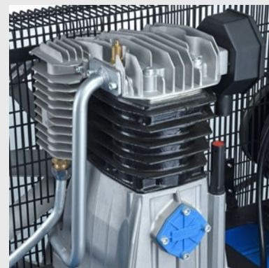
Dvoustupňový kompresor s tlakem 11 bar s dochlazovačem
