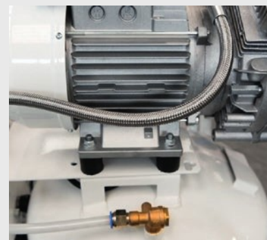
Přizbové podstavce pro snížení přenosu vibrací z kompresoru
